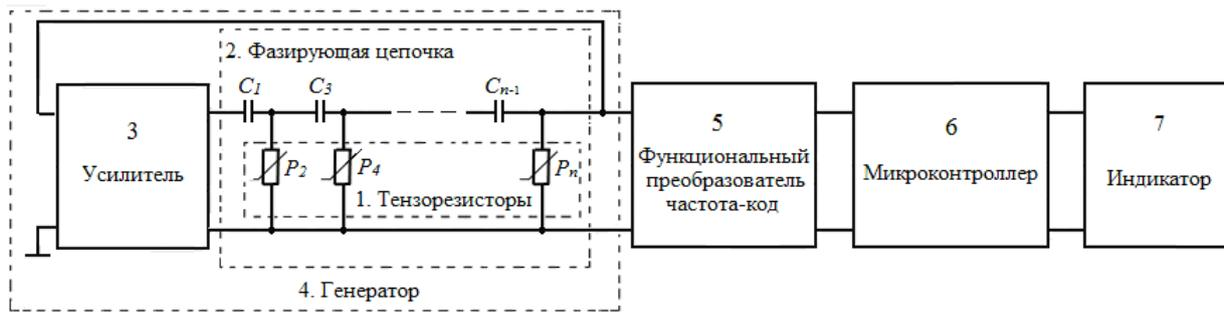
Рис. 2. Многоточечное частотное устройство измерения массы
