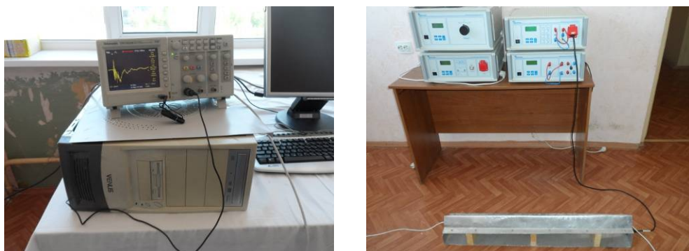
Рис. 2. Стенд для измерения электромагнитных помех в линии связи ЛВС при воздействии микросекундных импульсов
