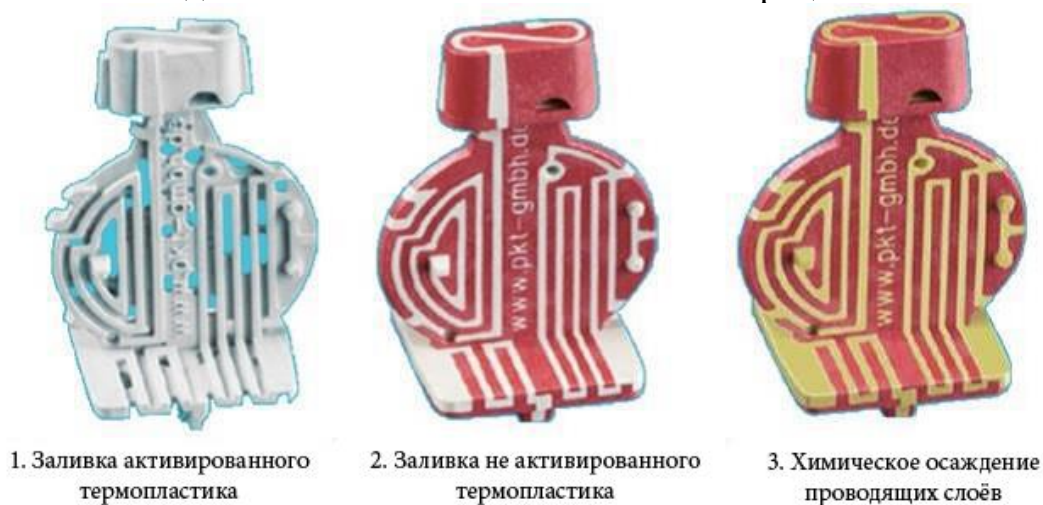
Рисунок 3 – Последовательность технологических операций в технологии 2S
