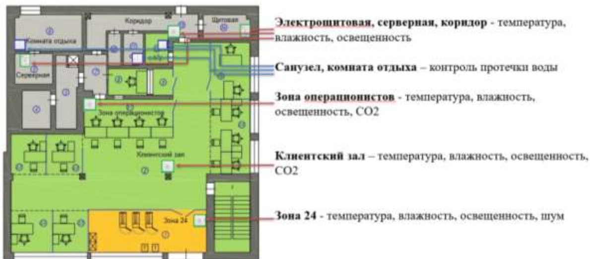
Рис. 1. Реализация системы управления энергоэффективностью помещения
