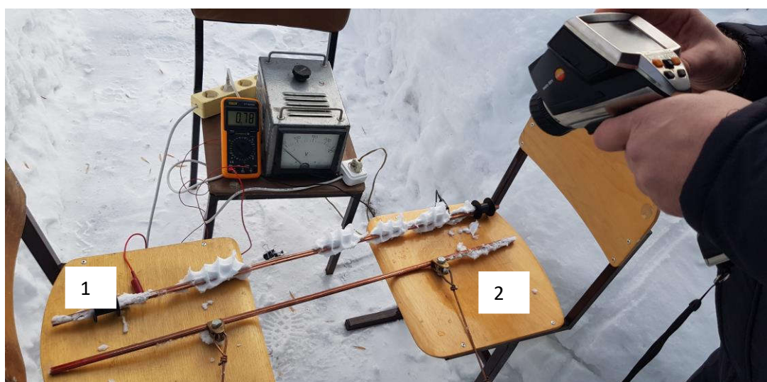
Рис. 2. Испытательный стенд устройства для борьбы с гололедом в реальных условиях
