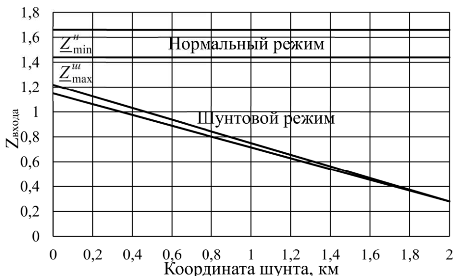
Рис. 2. График изменения входного импеданса при движении поезда от начала участка приближения до переезда
