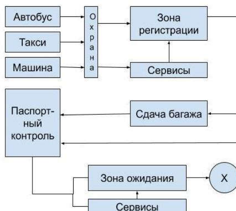
Рисунок 2 – Схема модели аэропорта в системе Anylogic
