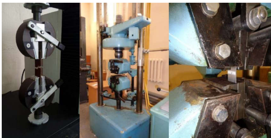
Рис. 6. Испытательный прибор для испытаний на растяжение DVT GP D NN Tensile
