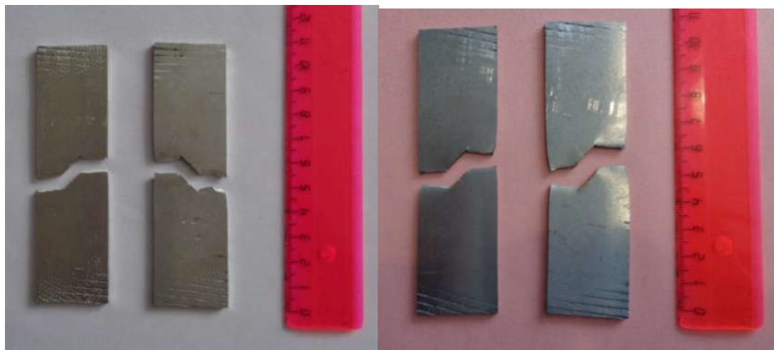
Рис. 5. Образцы с наклонной трещиной после разрушения
