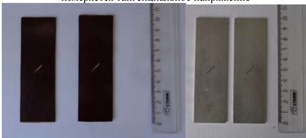
Рис. 2. Образцы с трещиной, выполненные из текстолита (слева) и сплава Д16Т (справа)
