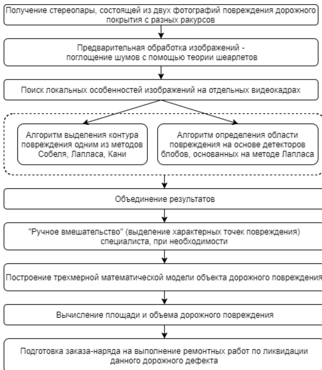
Рис. 2. Структура программно-алгоритмического комплекса распознавания повреждений дорожной поверхности
