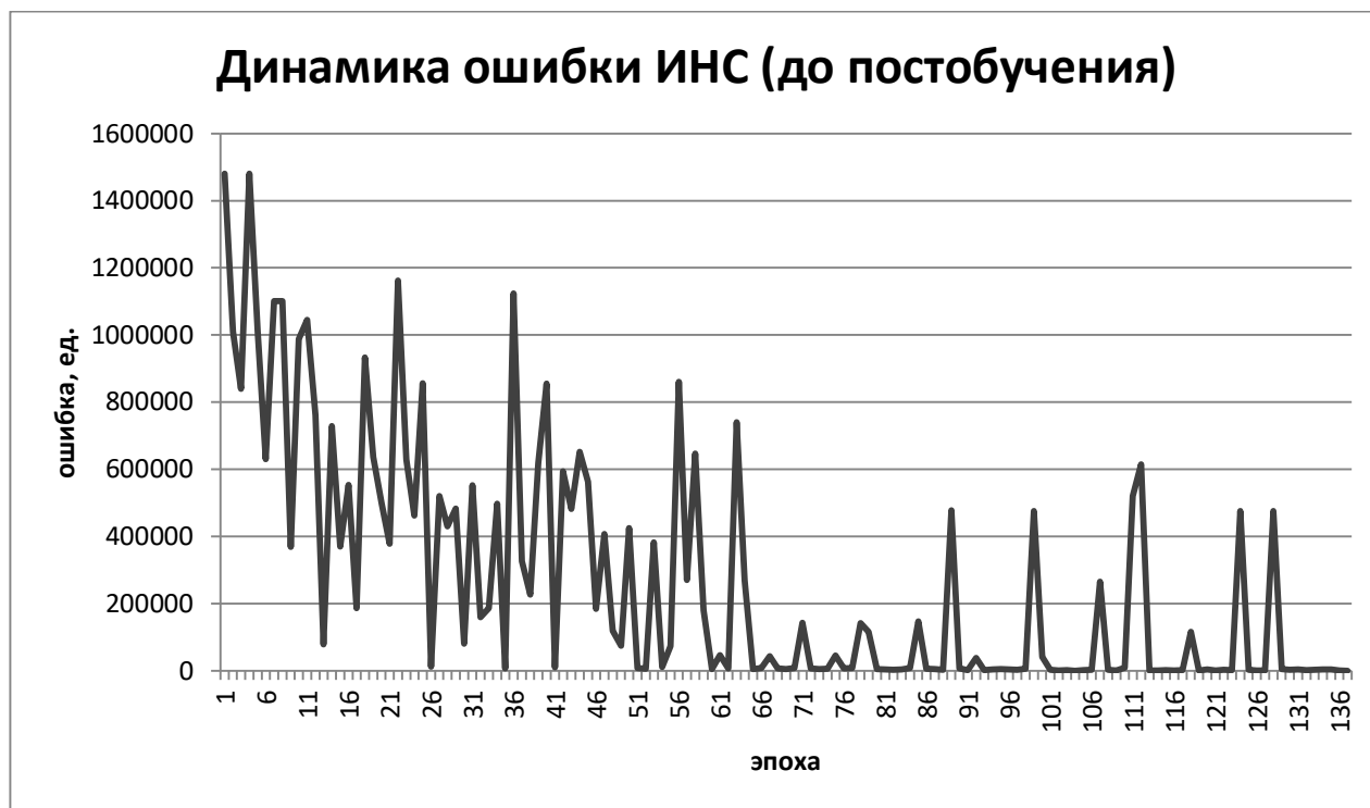
Рис. 1. Сигнал ошибки обычной многослойной ИНС
