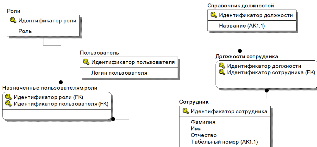
Рис. 1. Простейшая модель данных некоторых компонентов и отношений подсистемы разграничения данных и соответствующих им объектов уровня бизнес-логики
