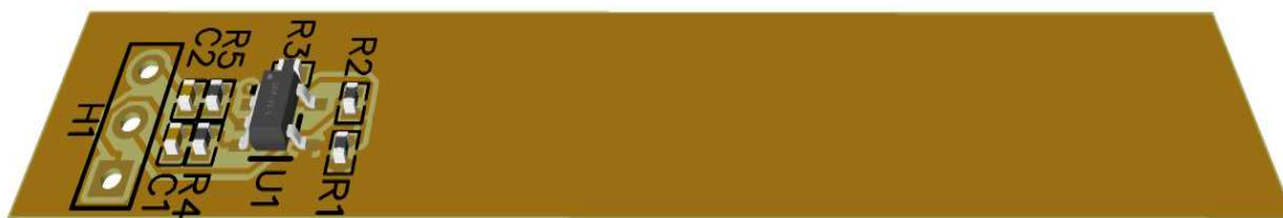
Рис. 3. Внешний вид платы предварительного усилителя и приемного электрода
