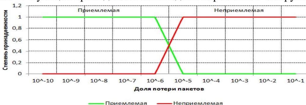
Рис. 2. Функций принадлежности входной переменной «Доля потери пакетов»
