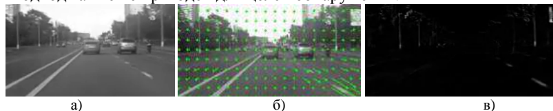
Рис.2. а) обычная последовательность из шоссе. Применение методов: б) оптико-поток, в) вычитание фона
