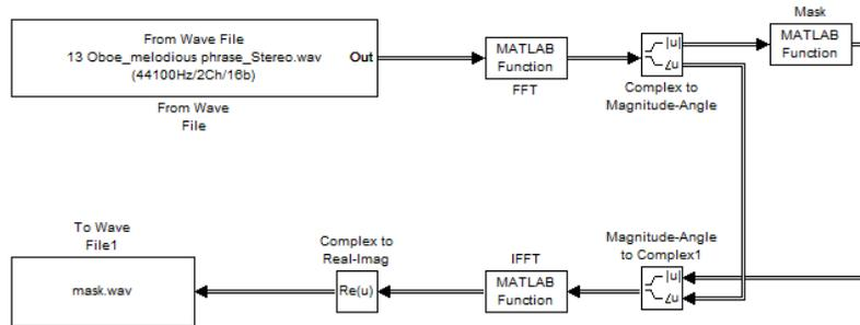
Рис. 2. Моделирование частотной избирательности слуха
