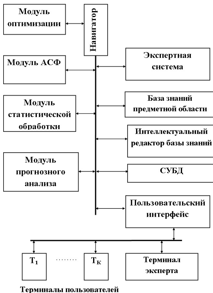
Рис. 1. Интеллектуальная система поддержки принятия решений при реконструкции производственных объектов
