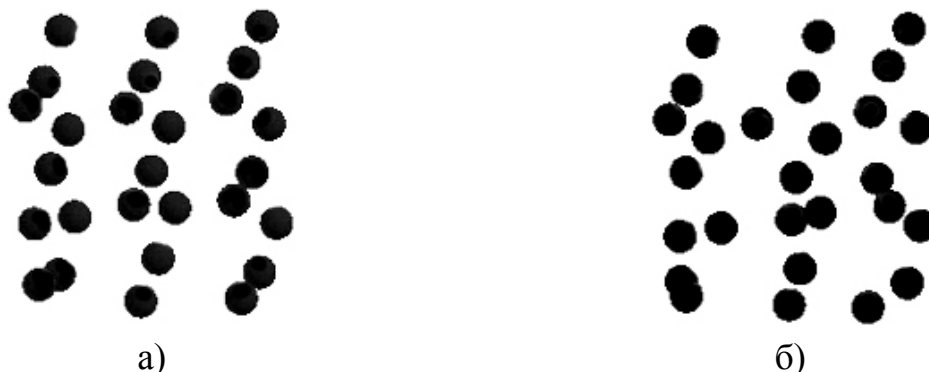
Рис. 4. Пример моделирования искажённой кубической решётки а) искажение только по вертикальной оси ( D_1=0.1, D_2=D_3=0 ), б) искажение по всем координатным осям ( D_1=D_2=D_3=0.1 )
