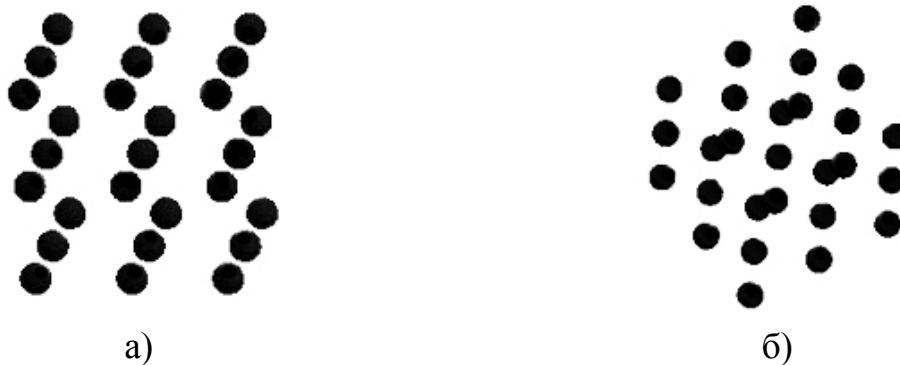
Рис. 3. Пример моделирования идеальной кубической решётки а) исходное расположение решётки без сдвигов и поворотов, б) случайное расположение решётки в пространстве
