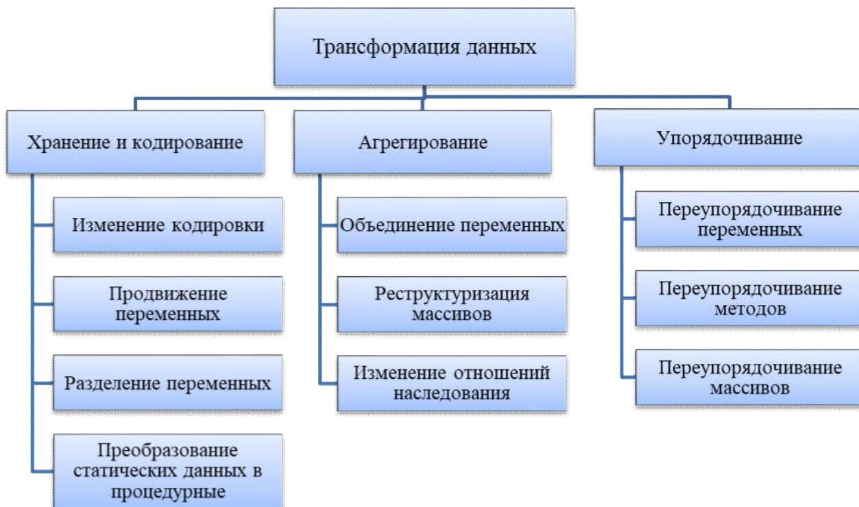
Рисунок 8 – Классификация обфускационных преобразований, использующих метод трансформации данных
