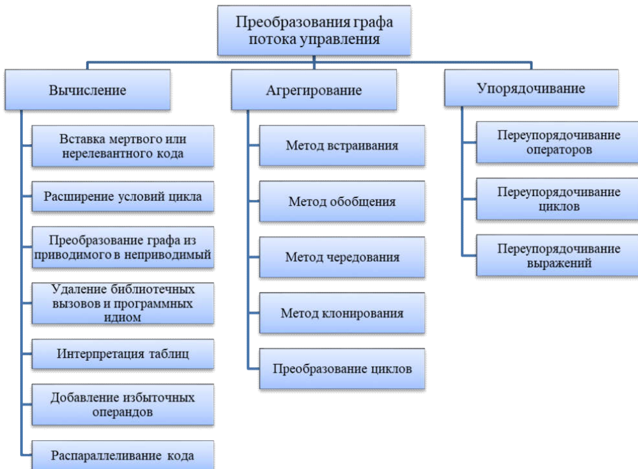
Рисунок 7 – Классификация обфускационных преобразований графа потока управления
