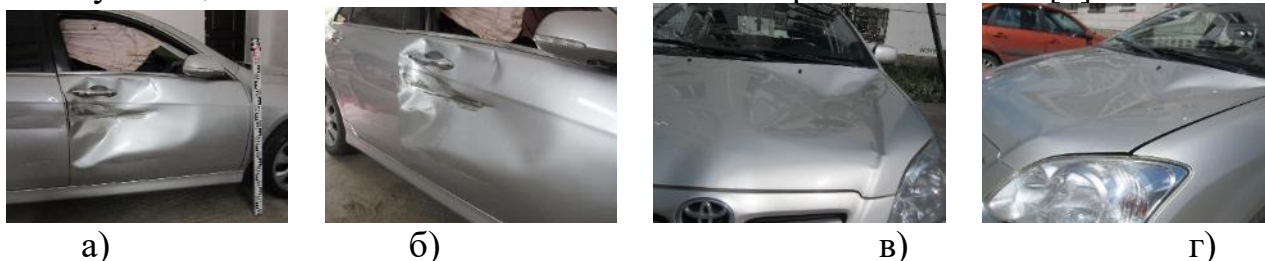
Рис. 2 Фотографии автомобиля: а) и б) повреждённого в ДТП, в) и г) повреждённого в результате падения снежной массы
