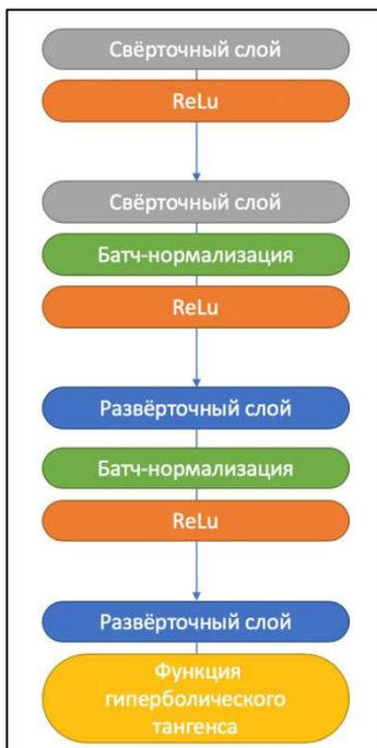
Рисунок 5 – Архитектура порождающей модели для восстановления изображений
