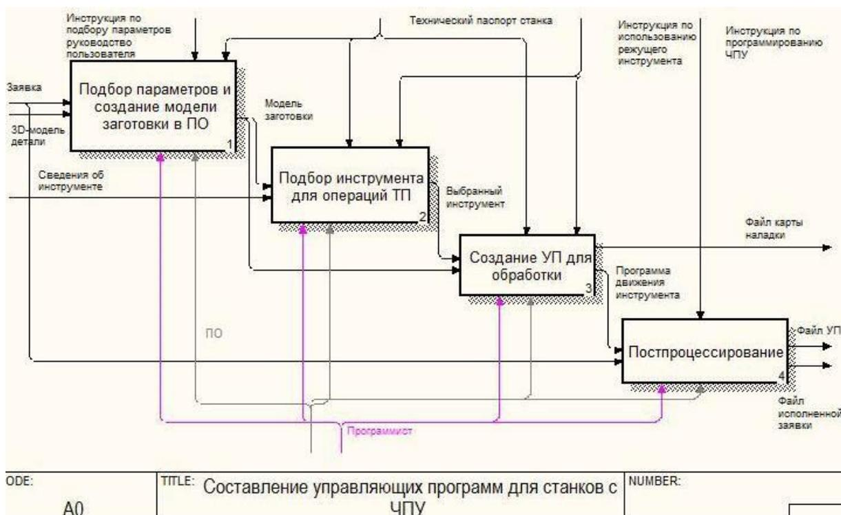
Рисунок 2 – Детальное представление контекстной диаграммы процесса составления управляющих программ для станков с ЧПУ
