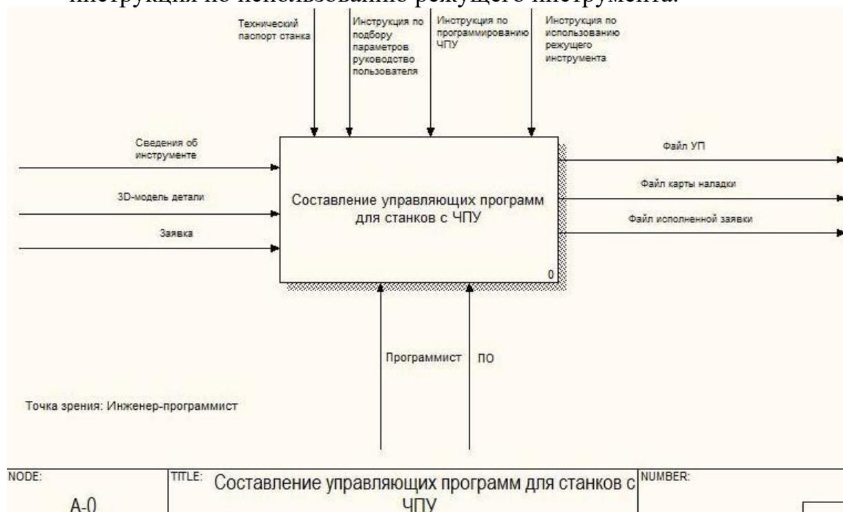
Рисунок 1 – Контекстная диаграмма процесса «Составление управляющих программ для станков с ЧПУ»
