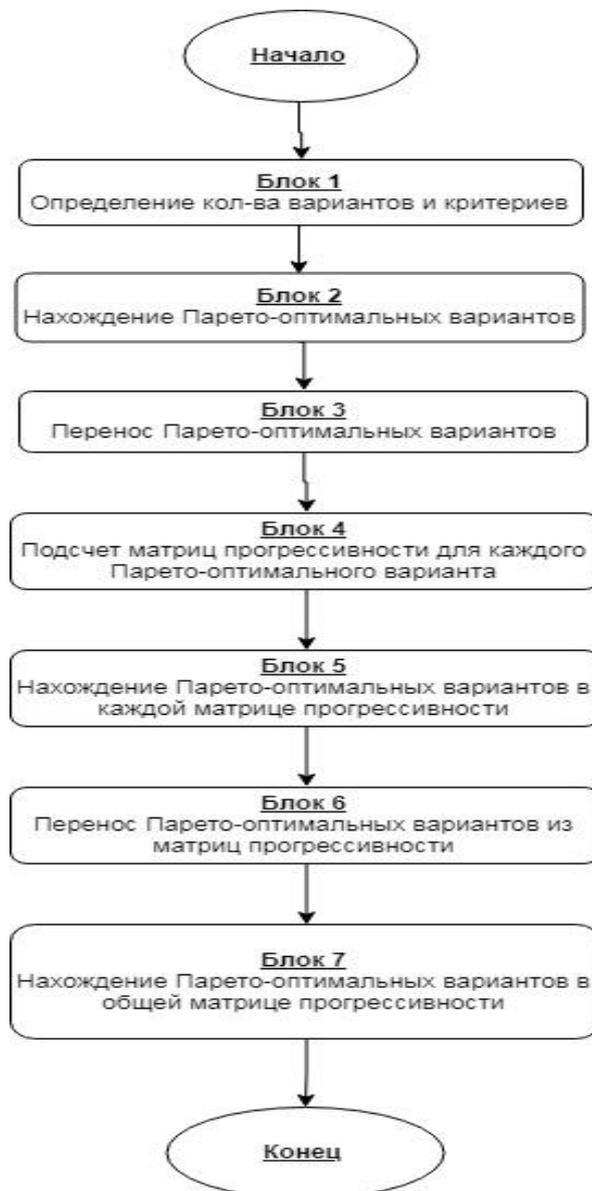
Рис. 1. Блок-схема алгоритма нахождения прогрессивных вариантов
