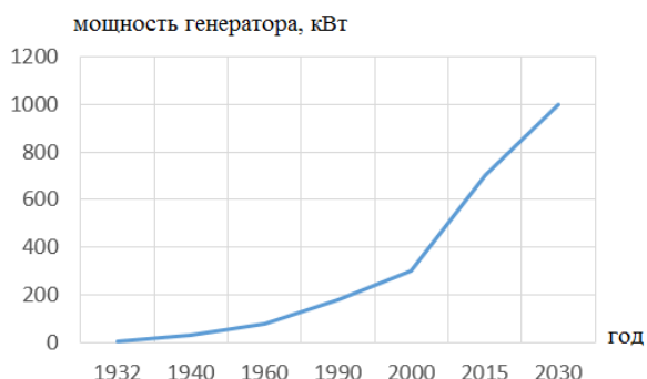
Рис. 1. Изменение мощности авиационных генераторов в различные периоды развития
