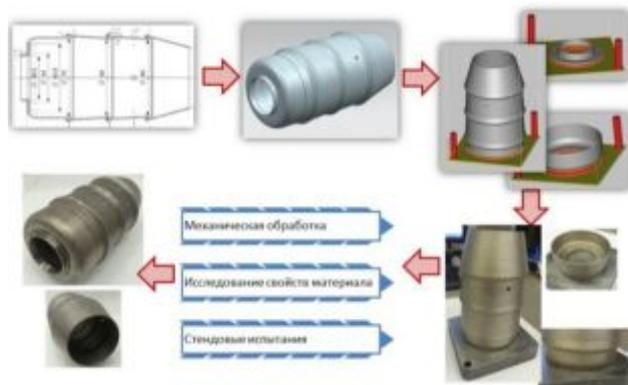
Рис. 1. Основные этапы технологического процесса изготовления КС
