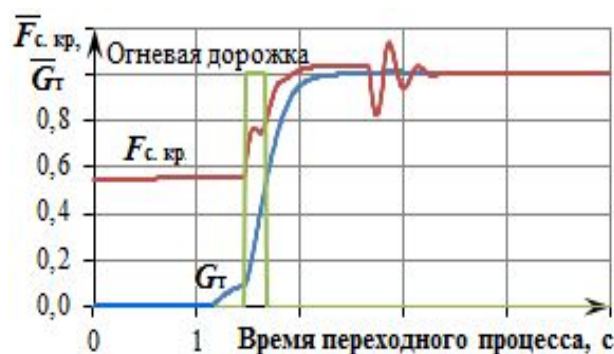
Рис. 3. Изменение относительной площади критического сечения сопла, расхода форсажного топлива и сигнала огневой дорожки
