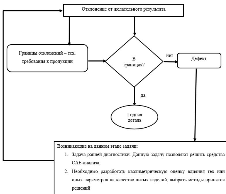
Рис. 1 – Схема использования САЕ-анализа при решении задачи ранней диагностики
