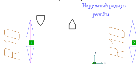
Рис. 2. Параметрические модели резов для нарезания метрической резьбы на стержне (слева) и в отверстии (справа)
