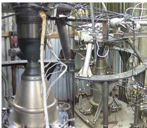
Рис. 2 – Огневые испытания КС ЖРД с соплом, изготовленным методом СЛС
