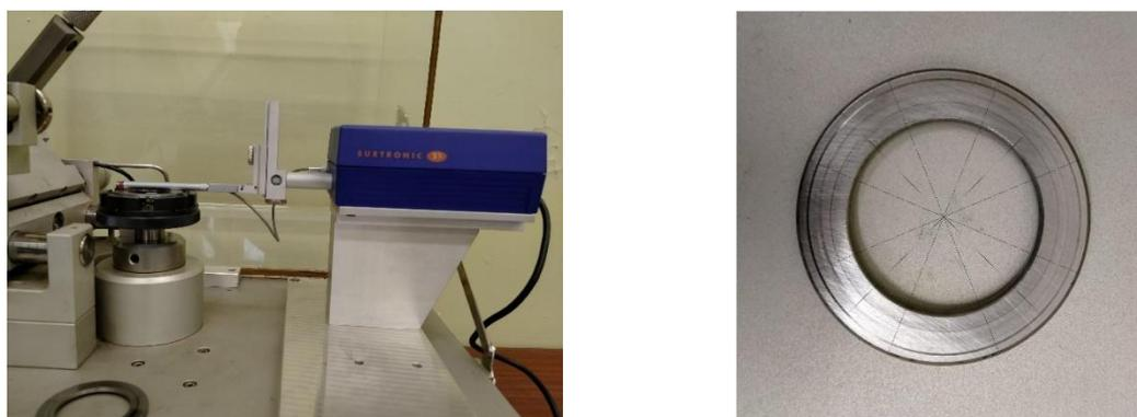
Рис. 1 – Измерение профиля поверхности кольца подшипника
