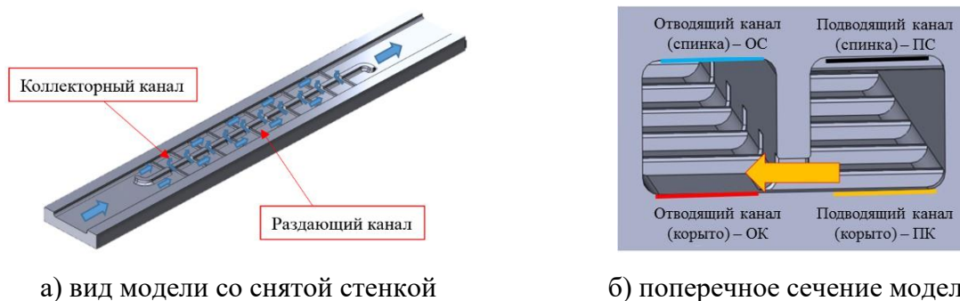
Рис.1 – Модель канала с несимметричным методом интенсификации
