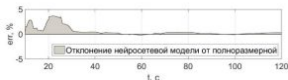
Рис. 3. Величина ошибки рассогласования нейросетевой модели от полноразмерной по частоте вращения ротора
