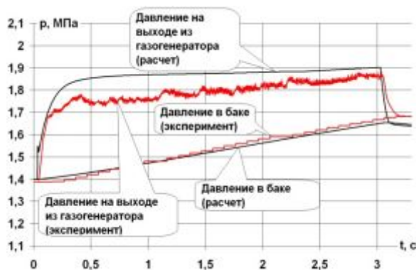
Рис. 2. Сравнение расчётных и экспериментальных данных. Объём газовой подушки в баке 20 л, длительность команды на включение газогенератора 3 с
