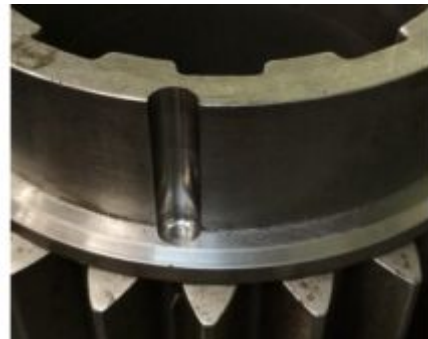
Рис. 3. Вал-шестерня после обработки отверстия
