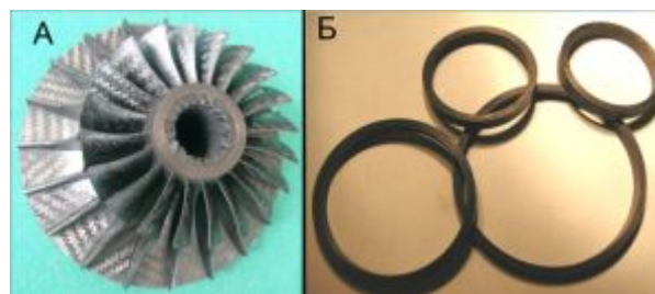
Рис. 1. Конструктивный облик РКЦК из КМ (а – собранный РКЦК, б – силовые кольца)
