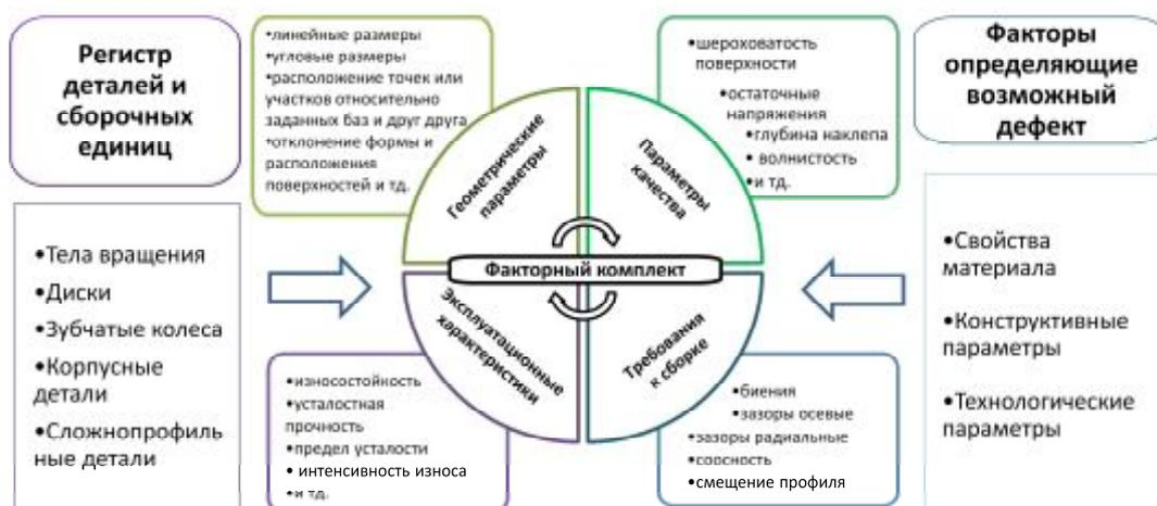
Рис. 1. Буфер дефектов деталей и узлов компрессоров ГТД
