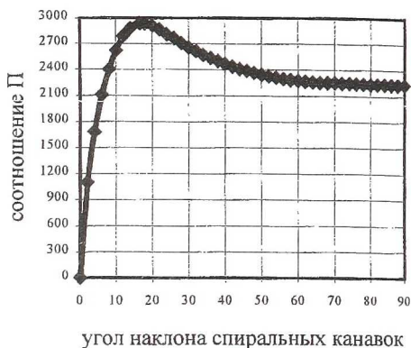
Рис. 6. Зависимости безразмерной жёсткости (а) и отношения жёсткости газового слоя к утечке уплотняемой среды (б) от угла наклона спиральных канавок
