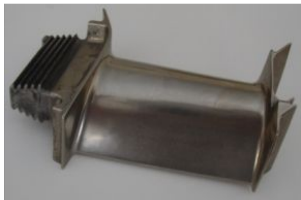
Рис. 2. Лопатка первой ступени турбины авиационного двигателя
