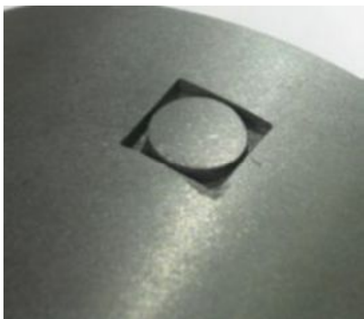
Рис. 2. Глухое углубление сложной формы в изделии из графита
