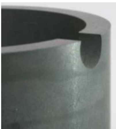
Рис. 1. Формообразование неполного отверстия в графитовом образце
