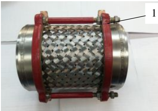
Рис. 2. Обработанная деталь «сильфон» 1 – сварной шов, после обработки
