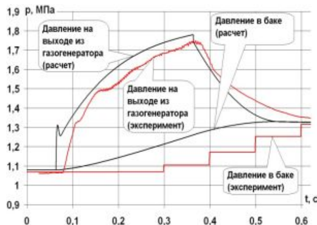
Рис. 1. Сравнение расчётных и экспериментальных данных. Объём газовой подушки в баке 2л, длительность команды на включение газогенератора 0,3 с
