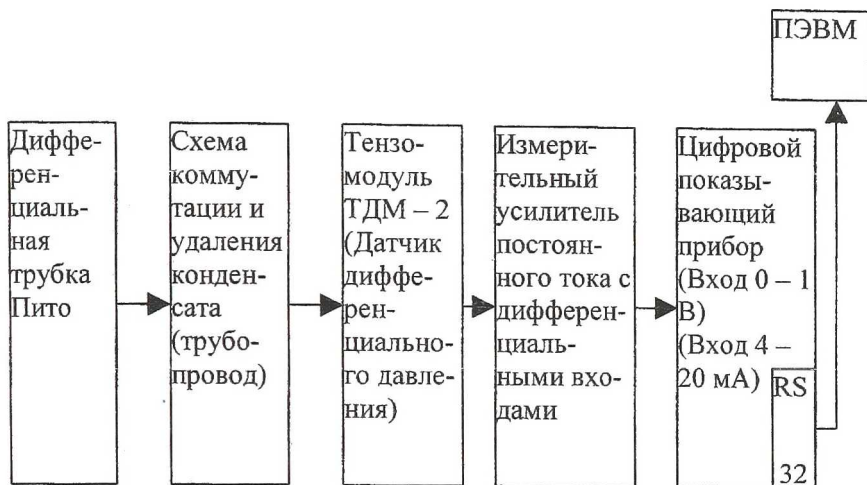
Рис. 5. Структурная схема измерителя расхода
