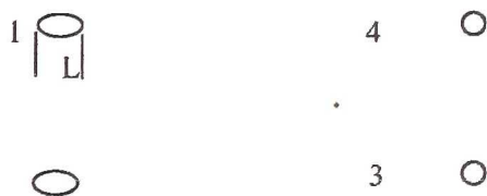
Рис.2. Характер выработки отверстий под резьбовые втулки после потери натяга в резьбе (вид против полета)
