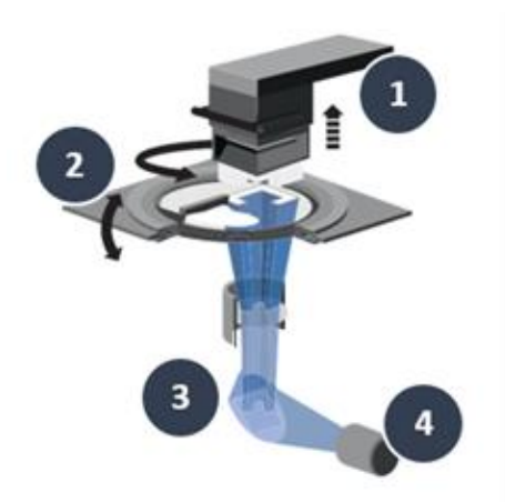
Рис.1 – Принципиальная схема LCM-технологии компании Lithoz:
