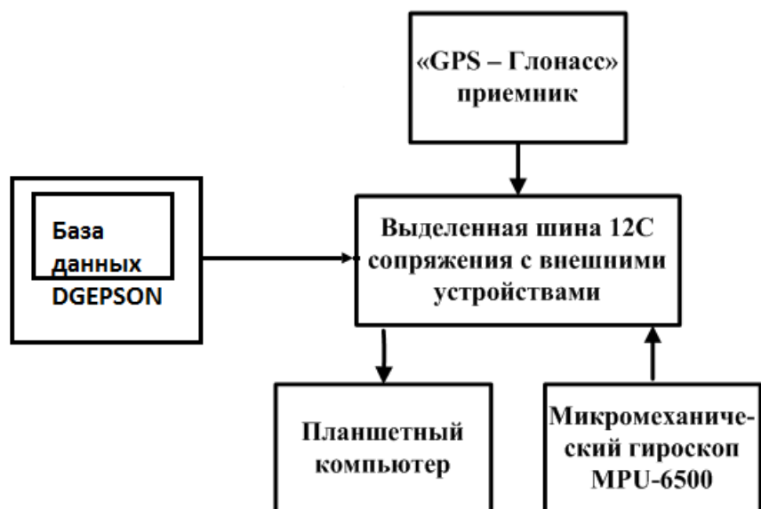
Рис. 1. Архитектурная схема технического решения визуализации пространственного положения самолётов на базе планшетного компьютера
