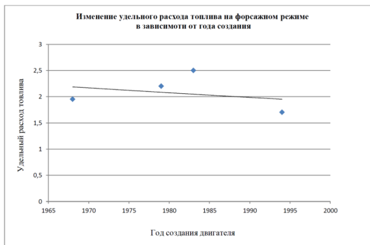
Рис. 3. Изменение удельного расхода топлива на форсажном режиме в зависимости от года создания
