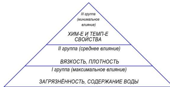
Рис. 1. Иерархия параметров состояния РЖ
