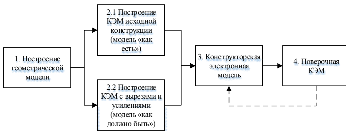
Рис. 1. Блок-схема методики проектирования усиления вырезов в фюзеляже
