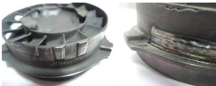
Рис. 1. Отливка статора турбины с наплавкой
