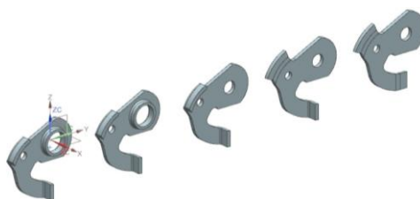
Рис. 3. Последовательность операций штамповки
