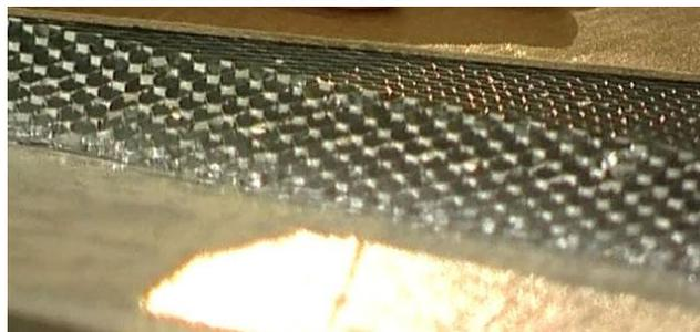
*Рис. 1. Образец композита. Внутри – алюминиевые соты, сверху и снизу – углепластик. Вместо алюминиевых сот предлагается использовать пористые полимерные материалы.*
